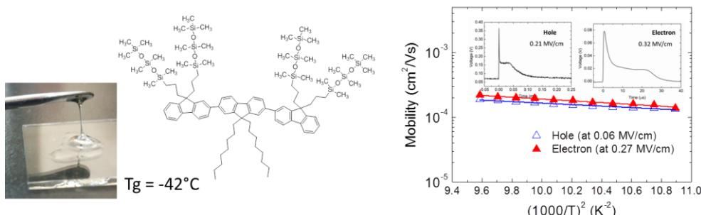
Exemple de semiconducteur liquide à température ambiante présentant un transport de charge ambipolaire avec des mobilités autour de  $10^{-4} \text{ cm}^2/\text{V.s}$ .
