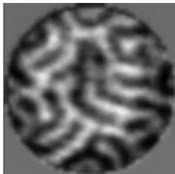
Figure 1 : Configuration en domaines magnétiques utilisant l'effet XMCD réalisé sur un film mince CoPd. On distingue des domaines magnétiques blancs et noirs correspondants à des orientations de spins up (blanc) et down (noir). La taille de l'image est de 1  $\mu$  m.
